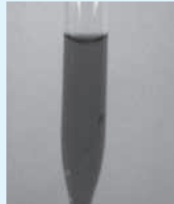
Menisco formado en mercurio dentro de un tubo. La concavidad es hacia abajo.
