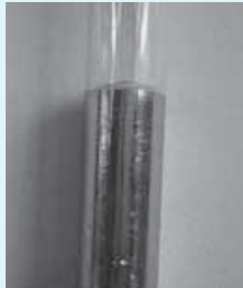
Menisco formado en agua con colorante dentro de un tubo de diámetro pequeño. La concavidad es hacia arriba.
